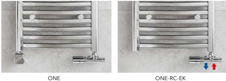
**Sada UNIKO** je určená pre napojenie kúpeľňových radiátorov v jednom pripojovacom bode s **roztečou 50 mm**. Elektrickú vykurovaciu tyč je možné inštalovať na ľubovoľnú stranu radiátoru (oproti ventilu). Termostatická hlavica umiestnená vždy na spatočke. Eurokonusové pripojenie. **Doporučujeme použiť zverné šróbenie UNIKO.**
